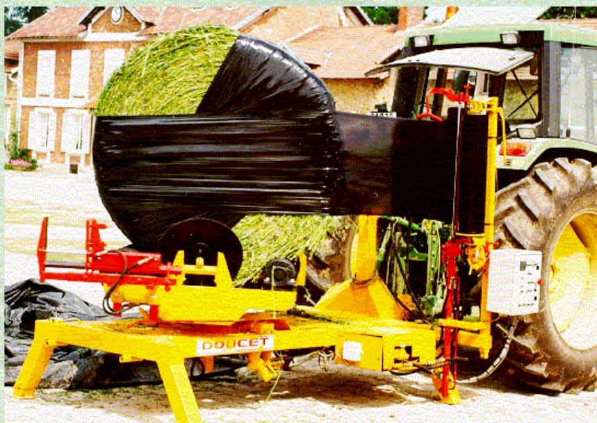
Principe d'une enrubanneuse - (Doucet)
