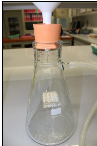
Figure 7 : la solution de lavage, plus l'eau osmosée ayant servi à rincer l'Erlenmeyer et à rincer les grains sont recueillies après filtration à 60 \mu\text{m} au fond de la première fiole à aspiration. Un volume de 300 à 400 mL peut être récupéré pour filtration dans le second dispositif équipé d'un filtre à 20 \mu\text{m} .
