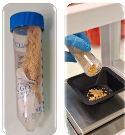
Figure 3 : Prise d'essai de sciure de pseudo-tronc de palmacées ou arecaceae (©ANSES LSV UBVO).
