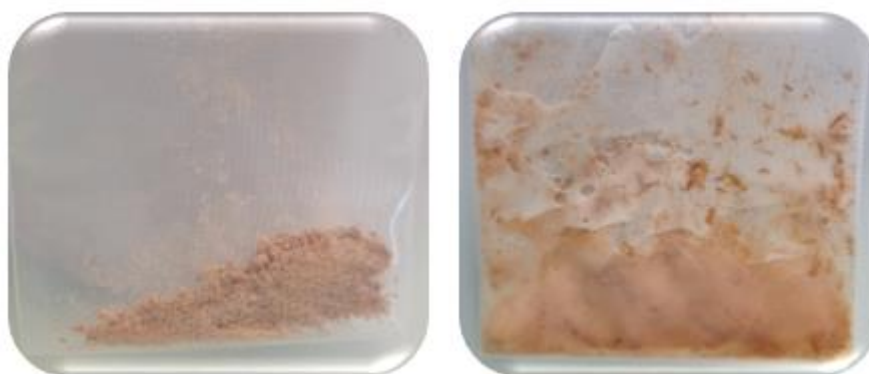
Figure 4 : Broyage d'un prélèvement de sciure (©ANSES LSV UBVO).
