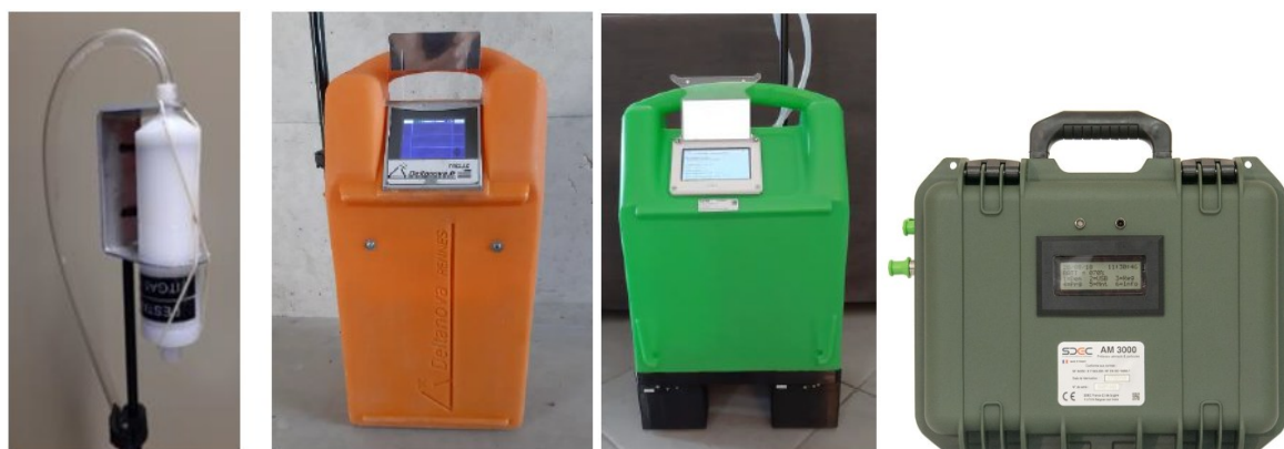
Figure 21 : Cartouche de prélèvement URG fixée sur son support et intégrée au mât de prélèvement de la pompe à une hauteur de 1m50 (gauche), pompe Deltanova GH18 (centre gauche), pompe RHX RB19 (centre droit) et pompe AM3000 (droite). PestiRiv, France, 2021-2022
