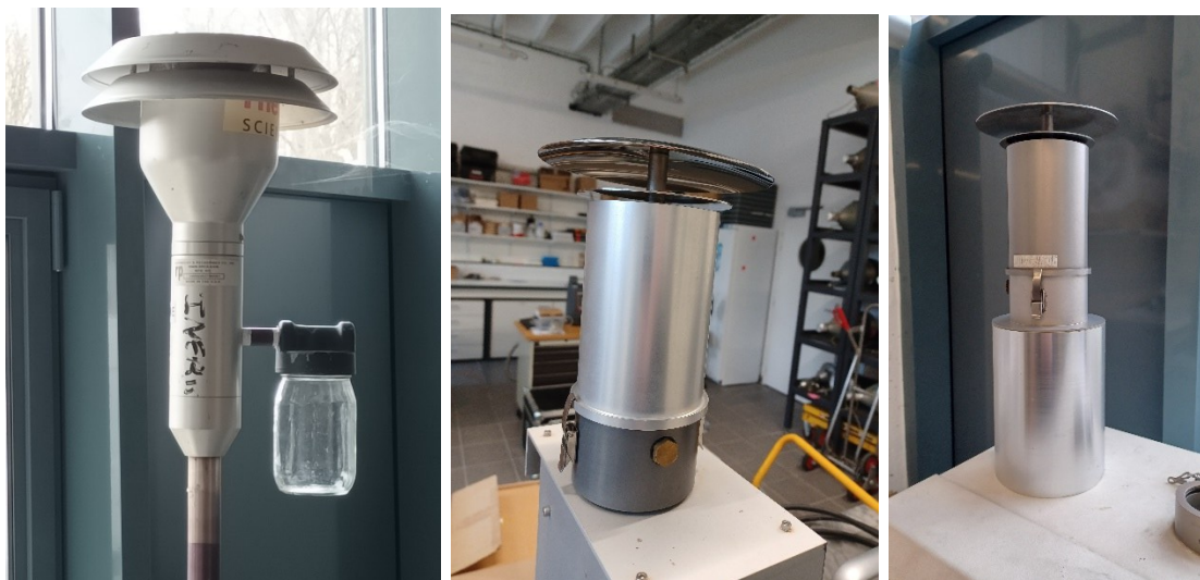
Figure 18 : Têtes PM10 pour Partisol, Leckel LVS6 et Leckel SEQ 47/50. PestiRiv, France, 2021-2022
