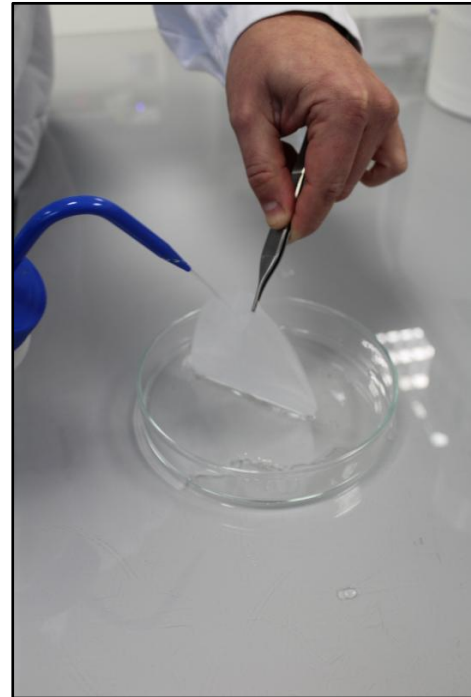
Figure 9 : le filtre à 20 \mu\text{m} est rincé sur sa face supérieure, à l'aide d'une pissette d'eau osmosée ou une micropipette, à raison de 10 à 15 mL. Le liquide de rinçage peut être réutilisé plusieurs fois si une micropipette à pointe à usage unique est utilisée. Réaliser des rinçages du haut vers le bas, pour détacher, et faire « descendre » du filtre les particules capturées.
