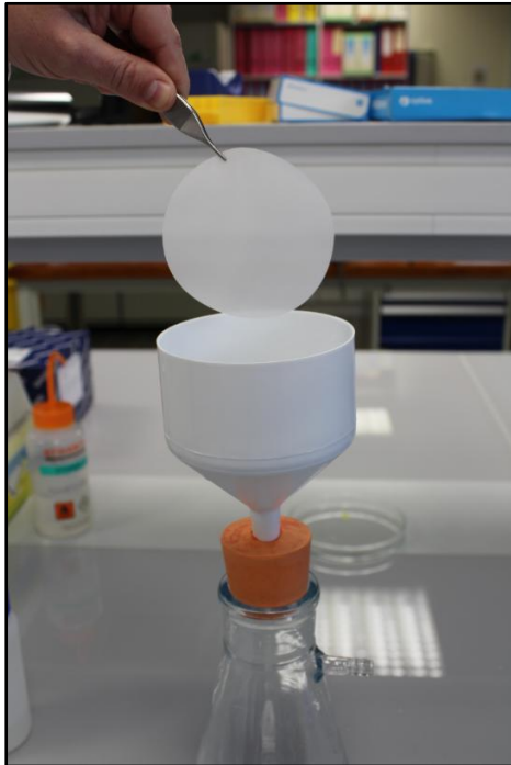
Figure 8 : après la seconde filtration sur le filtre à 20 \mu\text{m} , ce dernier a capturé les particules de tailles compatibles avec T. indica . Le filtre est délicatement récupéré à l'aide de pinces pour être rincé.
