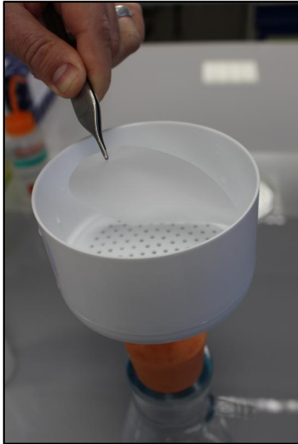
Figure 4 : Installation d'un filtre à 60 \mu\text{m} , qui sera suivi d'un rinçage à la pissette d'eau osmosée, pour lui permettre de bien adhérer au porte filtre.
