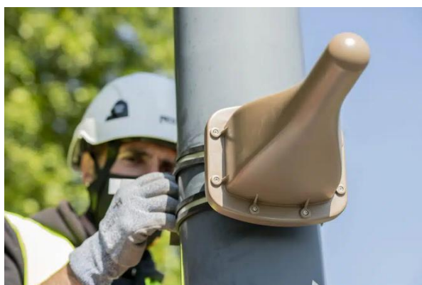
Figure 15 : Illustration d'outils de mesure de champ électromagnétique (1) : capteur fixe WAVE-001 de EXEM, et d'un exposimètre portable (2) : EME Guard XS 1 MHz – 40 000 MHz de MVG.
