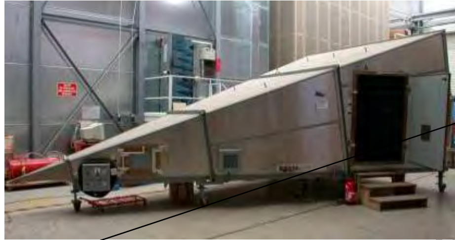
Figure 22 : Exemple de cellule GTEM de grande dimension (3 m x 1,6 m x 1 m).
