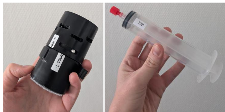
Illustration 1 : à gauche, échantillonneur VN Sampler déclenché après la détection d'un évènement feux/fumées/odeurs. À droite, seringue permettant le prélèvement d'air pour une mesure de monoxyde de carbone (Crédit : L. Bensefa-Colas).
