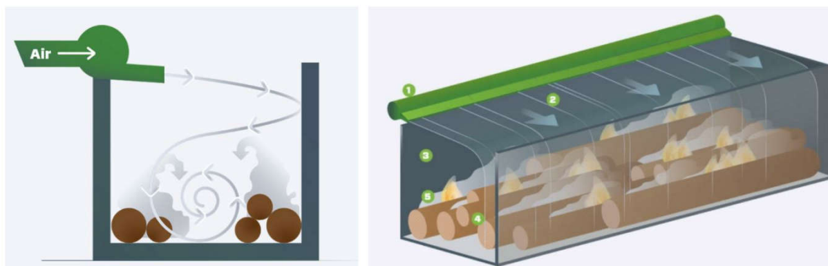
Figure 14 : Principe de l'incinérateur à rideau d'air (source : airburners.com lien consulté le 13 avril 2021)
